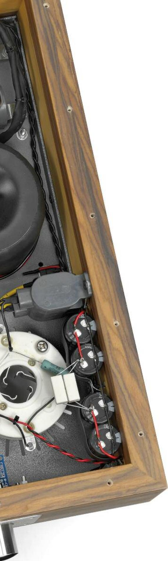
Auf diesen drei Grundzutaten basiert das Verstärkererfolgsrezept der Audiomanufaktur aus Ho-Chi-Minh-Stadt: sorgfältig ausgeführte Handarbeit, Point-to-Point-Kupferverdrahtung mit kurzen Signalwegen und eine Schaltung ohne „Bauteileballast“
