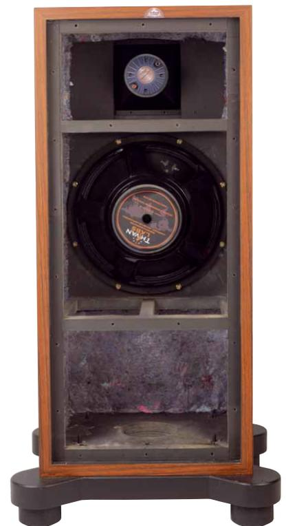
*Ja, das sieht schon sehr deutlich nach Männerlautsprecher aus. Die Dämmung des Gehäuses wurde angepasst*
