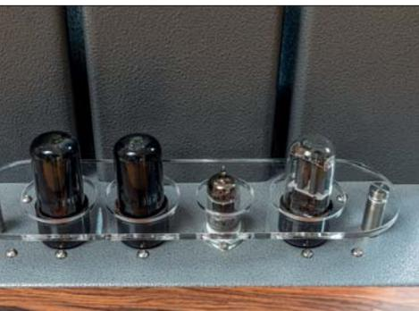
Links im Bild die beiden 6V6, die den Gitterstrom für die Endröhren des großen Vollverstärkers liefern
