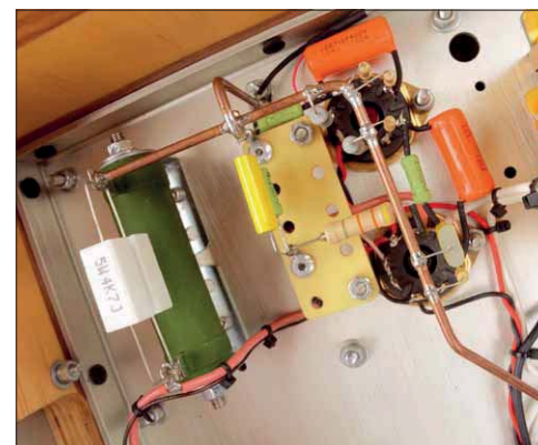
Oben: So geht bilderbuchmäßige Freiverdrahtung
