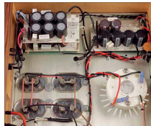
Die stabile Versorgung setzt auf reichlich Siebkapazität
