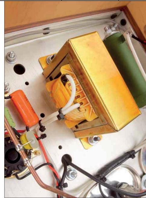
Dieser Trafo entkoppelt das Eingangssignal
