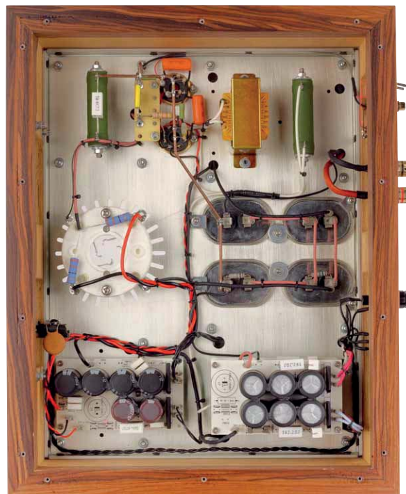
Oben: So geht bilderbuchmäßige Freiverdrahtung
