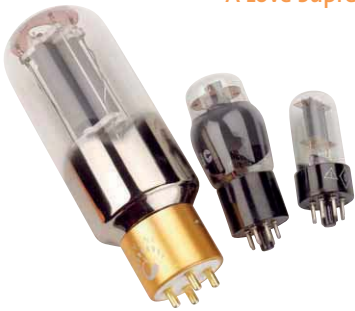
Die Röhrenbestückung: 211, 6V6, 6SN7
